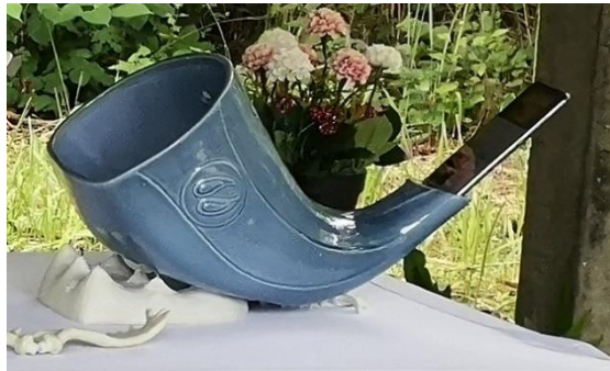
ภาพที่ 12 แสดงชิ้นงานเมื่อผ่านกระบวนการทางความร้อนที่อุณหภูมิ 1,200 องศาเซียส ไม่ดูดซึมน้ำและผลิตภัณฑ์ที่มีความแข็งแรงมากที่สุดในสามระดับอุณหภูมิ
