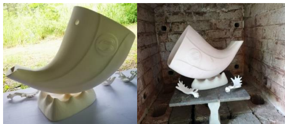
ภาพที่ 11 แสดงชิ้นงานเมื่อผ่านกระบวนการทางความร้อนที่อุณหภูมิ 800 องศาเซียสยังมีการดูดซึมน้ำได้อยู่
