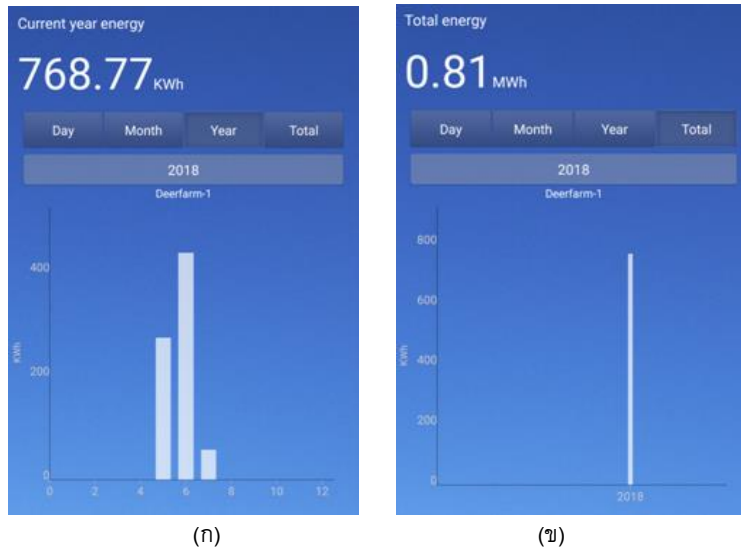
ภาพที่ 9 (ก) ผลการทดสอบวัดค่าพลังงานไฟฟ้ารวมแต่ละเดือนต่อปี ทั้ง 3 จุดรวมกัน ที่ติดตั้งเซลล์แสงอาทิตย์ และ (ข) ผลการทดสอบวัดค่าพลังงานไฟฟ้ารวมทั้งปี ทั้ง 3 จุดรวมกัน
